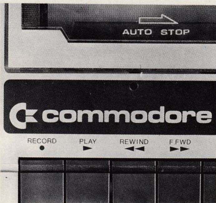
Figura 1. Nella fotografia è evidenziato il foro attraverso il quale è possibile regolare la vite di registrazione della testina.
